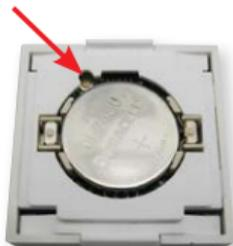
Um die Verbindung zu trennen, aktivieren Sie den Bildschirm und halten Sie die Reset-Taste an der Rückseite der Tastenbedienung lange gedrückt (> 5 Sek.).
