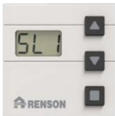
Verwenden Sie ▲ oder ▼, um die Lüftungsstufe zu ändern (L1–L4).
