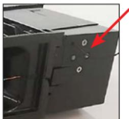
Drücken Sie auf die LED, die sich am nächsten zur Antenne am Steuerkasten des Endura® Twist befindet, um das Signal zu öffnen. Die LED blinkt rot, solange die Verbindung nicht hergestellt ist. Die rote LED hört auf zu blinken, sobald die Tastenbedienung und das Endura® Twist verbunden sind.
